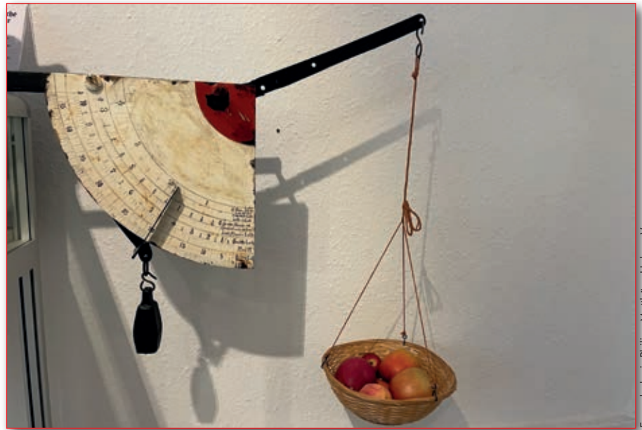
Um 1765 entwickelte Hahn einen neuen Typus Waage, die Neigungswaage.
