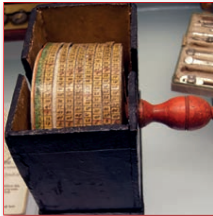
Ein Vorläufer Hahns Rechenmaschine ist diese Rechentrommel. Sie nutzte konzentrische Zahnräder und Staffelwalzen und wurde um 1770 entwickelt.
