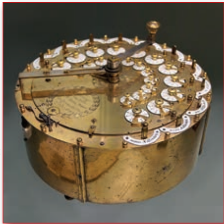
Die von Hahn entwickelte Rechenmaschine. Sie gilt als erste voll funktionsfähige Maschine für alle vier Grundrechenarten (Addition, Subtraktion, Multiplikation, Division).
